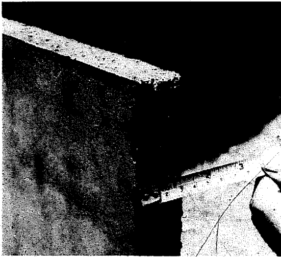
Figura 4-28 Plaqueta de 3 centímetros de espesor hecha en bambú-cemento.
