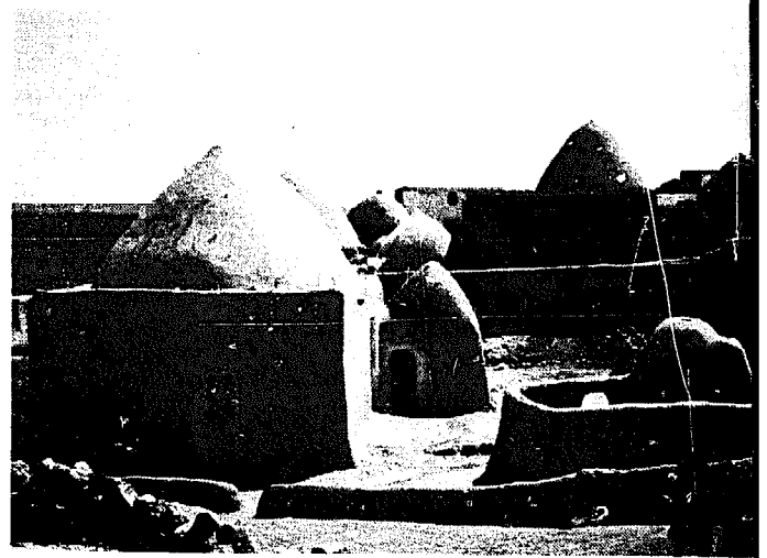
FIGURE 320 : LES « COUPOLES » EN ENCORBELLEMENT SONT PRESQUE TOUJOURS CONIQUES (SYRIE)
