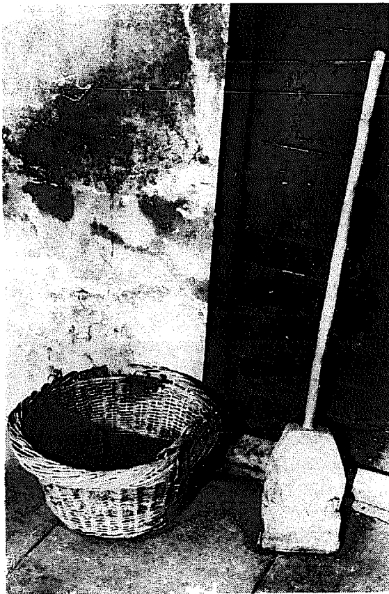
FIGURE 52 : CORBEILLE ET PISOIR UTILISÉ TRADITIONNELLEMENT
