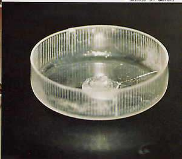
▲試料水をスポイトで取り出し、シャーレに1滴落とし、凍らせている様子 Placing a drop of water to be tested into a Petri dish using a pipette.
