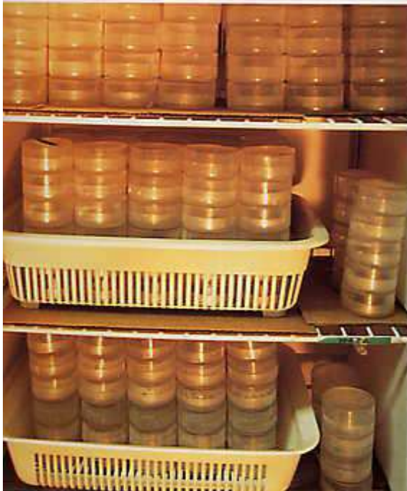
▲冷凍庫。1つの試料水を100個のシャーレに分けて、氷結させている様子 Freezer Water to be tested is divided into 100 Petri dishes for freezing.
