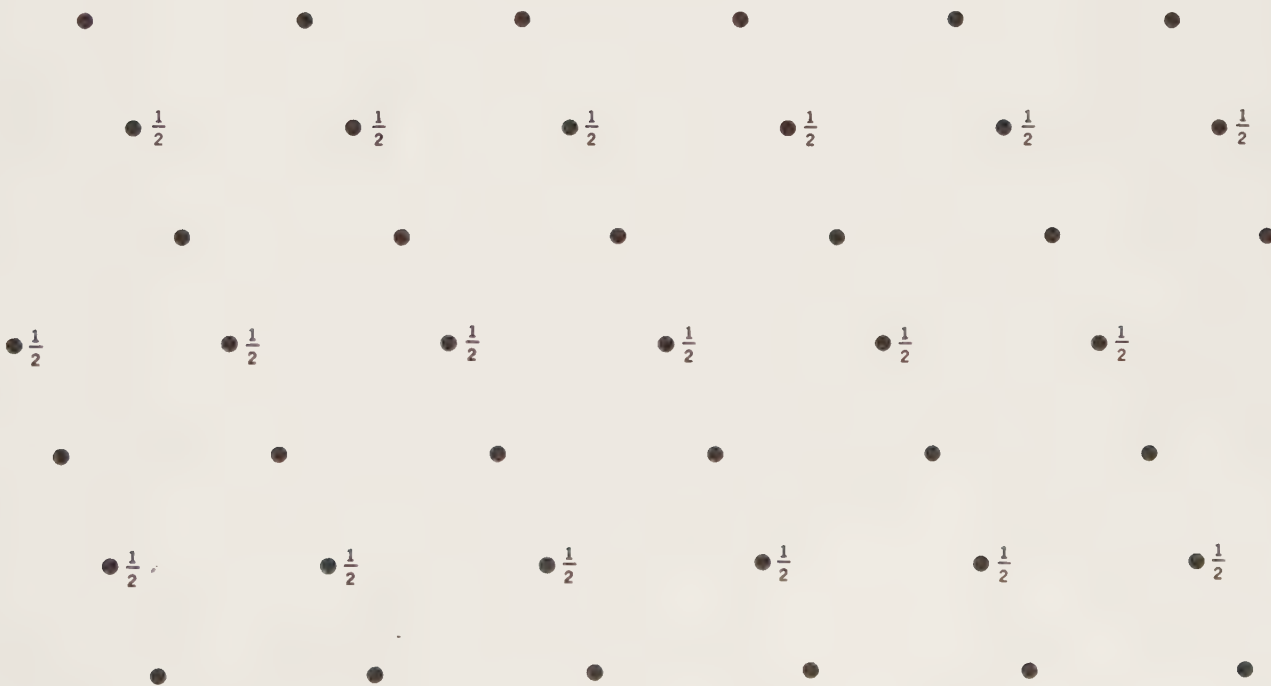
(d) Monoclinic lattice with the b axis perpendicular to the page
