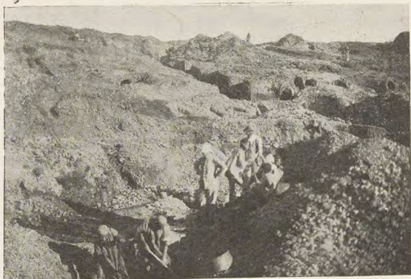
Lavage et pilonnage du quartz, à Andranofito
