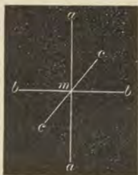
Fig. 15. Achsenkreuz. a a Hauptachse, b b und c c Nebenachsen, m Mittelpunkt.
