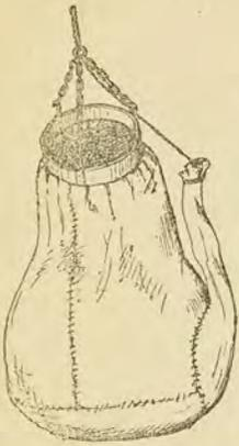
Elles ont à la partie inférieure une espèce de tuyau en forme de trompe d'éléphant pour laisser couler l'eau à la sortie du puits. Pendant l'ascension, ce tuyau est attaché au câble par une corde. A la partie supérieure, la peau est solidement attachée à un cercle de fer, pouvant s'accrocher aux brides du câble.
