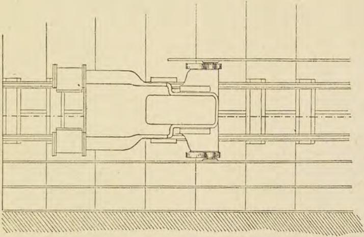
La machine horizontale est aussi installée en face du gradin à découper; lorsqu'on a à faire des entailles à côté des parois de la galerie, il faut toujours pratiquer une excavation de 0,40 avec le pic, pour installer la voie de roulage sur laquelle doit circuler la machine horizontale.
