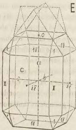
$A, b, c$ , son los ejes, de los cuales,  $a$  es el vertical;  $b$  el mas corto lateral, se llama *brachydiagonal*, i  $c$  el mas largo lateral, *macrodiagonal*. O es el plano *básico* del prisma;  $i : \bar{i}$  el plano lateral mas ancho, paralelo al eje lateral mas *largo*;  $i : \bar{i}$  el plano lateral mas angosto, paralelo al eje lateral mas *corto*.
