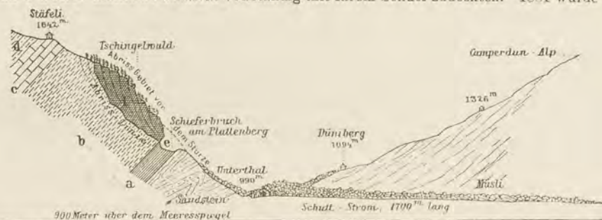
Fig. 183. Profil durch das Gebiet des Bergsturzes bei Elm vom 11. September 1881 nach A. Heim. a eocäne Dachschiefer, b weichere Schiefer, c Nummulitenkalk, d Schiefer, e ehemaliger Schieferbruch, f abgestürzte Schiefermasse.
