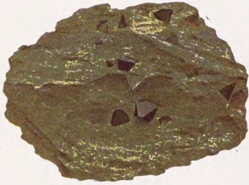
2. Magnetit in Chlorit von Zermatt
