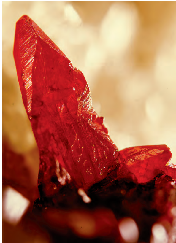
Abb. 3.17. Proustit mit vorherrschender ditrigonaler Pyramide \{21\bar{3}1\} . Chanaracillo, Chile. Bildbreite ca. 2 mm. Mineralogisches Museum der Universität Würzburg. (Foto: K.-P. Kelber)
