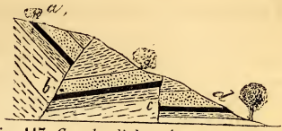
Fig. 113. Couche disloquée par des failles.
