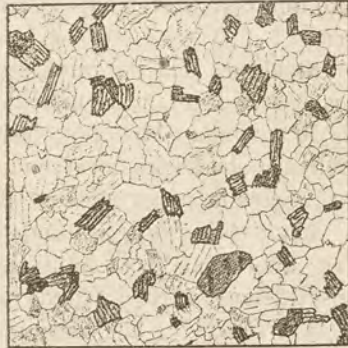
Fig. 128. Bergart med kristallinisk textur. (Granit, förstorad 5 gr.)
