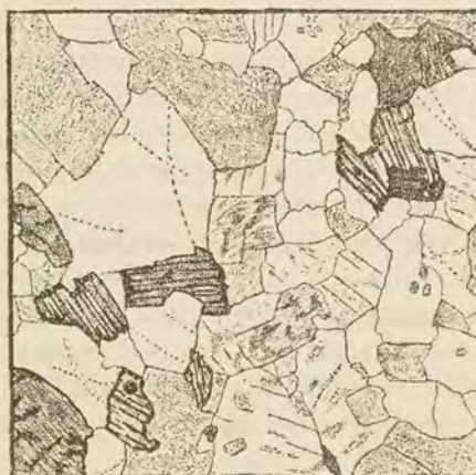
Fig. 133. Bergart med oregelbundet kornigt utbildad fältspat (Granit, \times 10 ). De hvita partierna äro kvarts (de prickade linierna utmärka rader af vätskeinneslutningar); de ljusa, svagt fläckiga, partierna ortoklas (de enstaka raka strecken utmärka genomgångarne); de ljusgrå partierna oligoklas (vittråd); de mörka, strimliga partierna glimmer.
