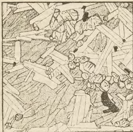
Fig. 132. Bergart med tafvelformigt utbildad fältspat (Diabas, \times 18 ). De ljusa, långsträcktta partierna äro fältspat; de grå augit; de ljusa, runda kornen olivin, de svarta magnetit.
