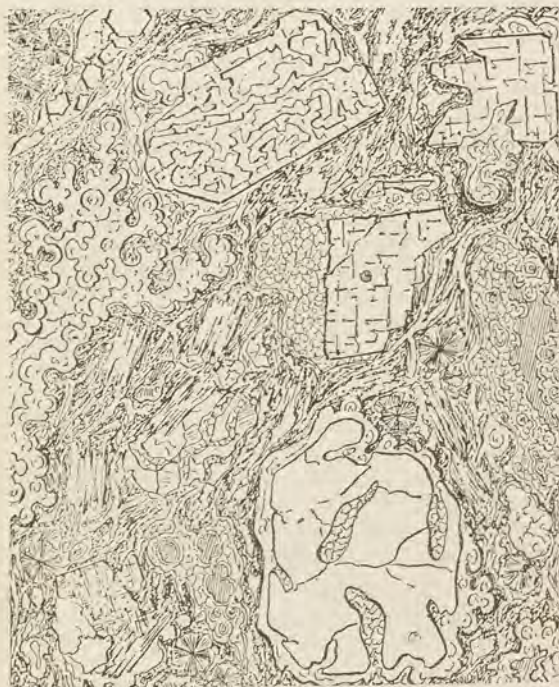
Fig. 67. — Porphyre pétrosiliceux vu au microscope polarisant montrant des corrosions caractéristiques des quartz anciens (d'après Vélain).
