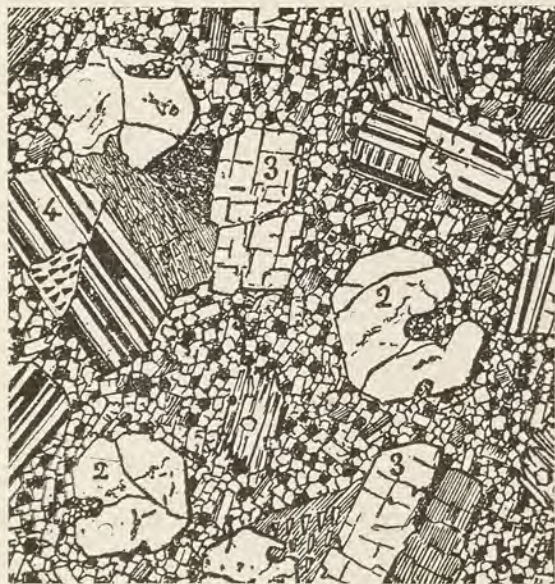
Fig. 62. — Microgranulite des Vosges (d'après Vélain). — 1, mica noir avec inclusion d'apatite. — 2, quartz bipyramidé. — 3, orthose. — 4, oligoclase. — 5, quartz et orthose en association microgranulitique. — 6, micropegmatoïde.
