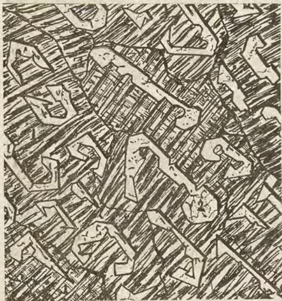
Fig. 63. — Pegmatite des Vosges (d'après Vélain). — 1, microcline. — 2, quartz pegmatoïde.
