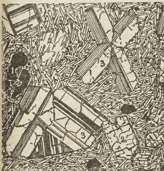
Fig. 75. — Diabasophyre des Vosges (d'après Vélain). — 1, fer oxydulé — 2, augite. — 3, labrador. — 4, microlithes d'oligoclase et de fer oxydulé.
