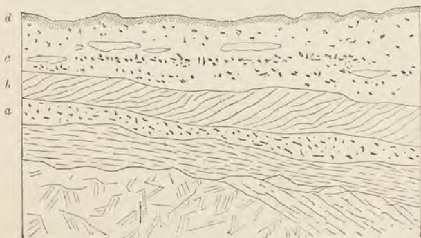
Fig. 84. — Gisement de Bangka. — 1, granite. — 2, schistes, métamorphiques; a, gisement d'étain; b, sable grossier; c, argile; d, sable grossier et sable fin avec un peu de minerai.
