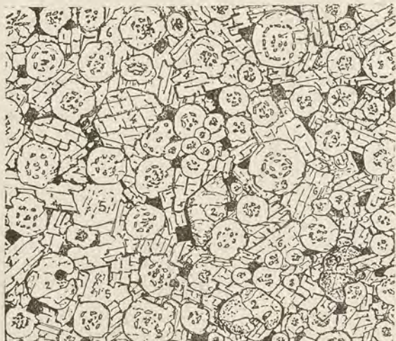
Fig. 78. — Leucite du Vésuve (d'après Vélain). — I. Éléments de première consolidation . — 1, magnétite. — 2, péridot. — 3, leucite. — 4, augite. — II. Éléments de seconde consolidation . — 5, microlithes d'augite et de fer oxydulé. — 6, ménilite.
