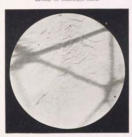
Internal Cracks & Fissures Crevasses intérieures
