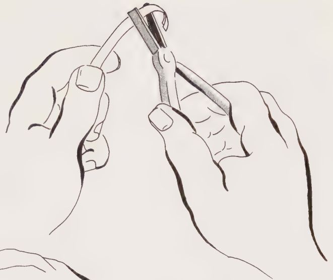
Diag. 37 Forming a bezel from bezel strip using pliers
