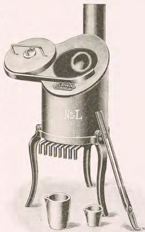
Abb. 5. Kleiner Schmelzofen. (St. Grötz, Pforzheim.)
