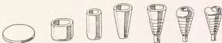
Abb. 117. Herstellung einer Karabinerkapsel.
