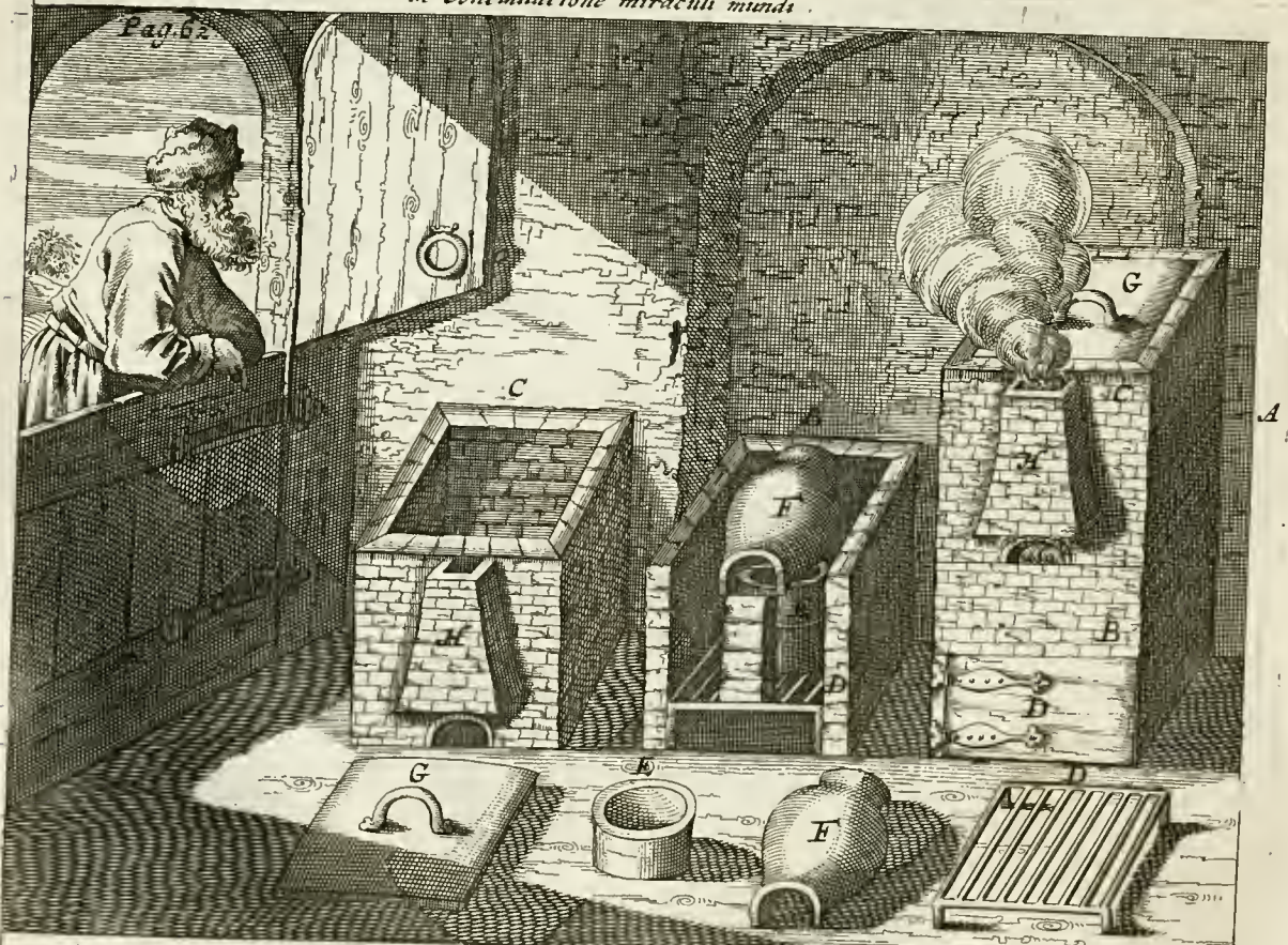
A. Ist der Ofen wie er in der arbeit steht. C. Ist das obertheil des Ofens B. Ist der Untertheil des Ofens wie er D. Der rosth in dem Ofen. E. der Herd. G. der Deckel dar mit der Ofen oben gedecket wird wann kohlen dar in sein und in voller arbeit steht. H. das rauch fanglein an dem Ofen.
