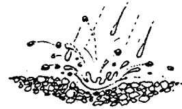
Cuando la lluvia golpea el suelo descubierta, se lleva la tierra.
