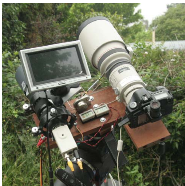
Fig. 7.13. A video finderscope setup by Albert Van Donkelaar.
