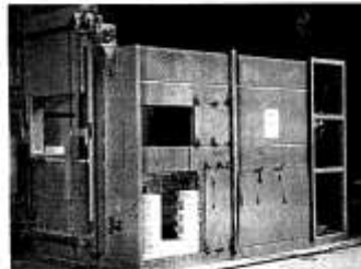
Four C 411 en cours de fabrication
