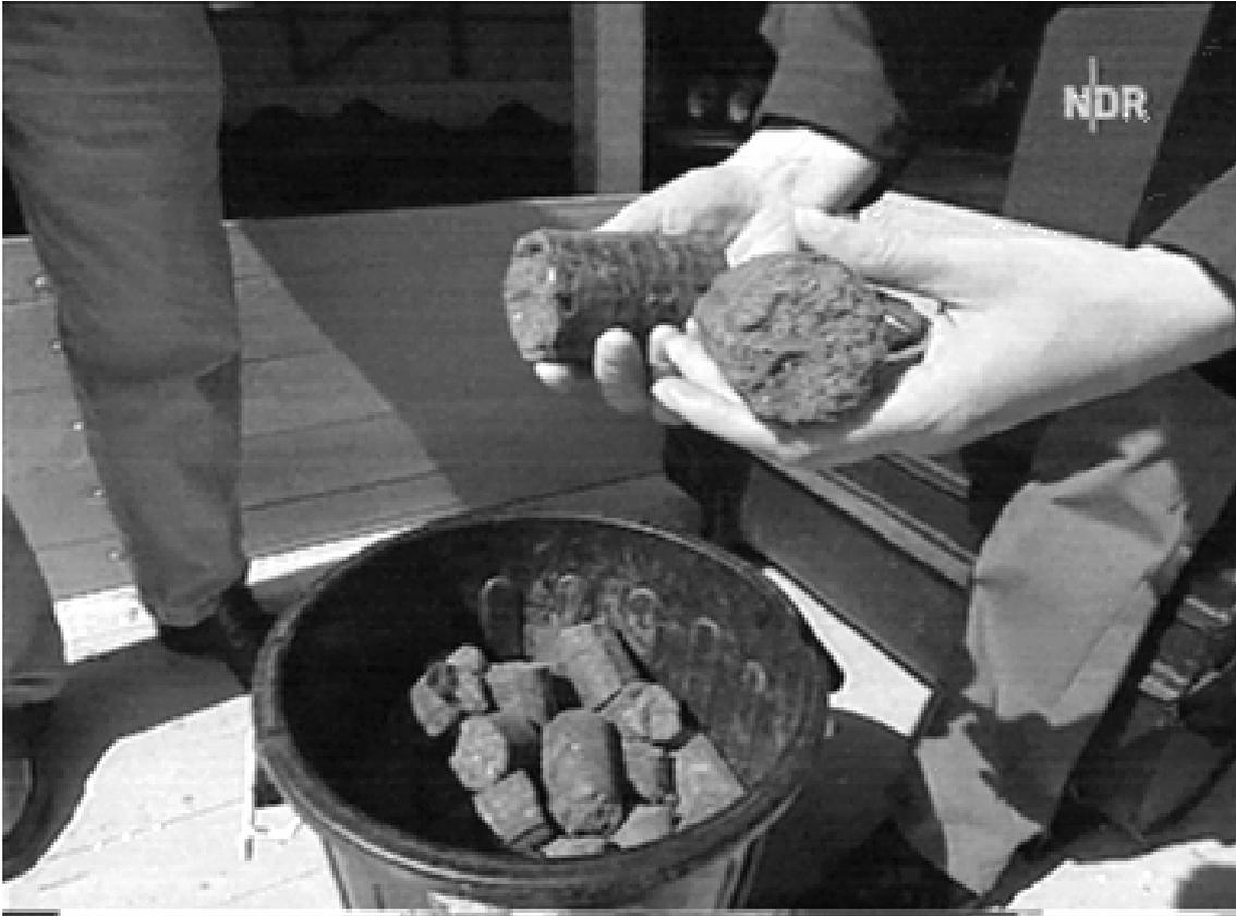
Das „Heizmaterial“ für den „Gasgenerator“ : Brikettierter Stallmist
