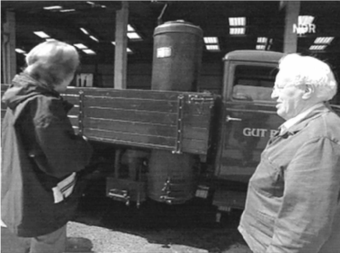
Der Gasgenerator als Energiequelle eines „Opel Blitz“ LKWs
