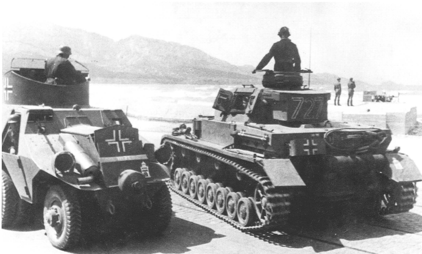
Samochód pancerny ADGZ (8x8) i PzKpfw IV Sd Kfz 161 Ausf. F1 z 3. Policijnej Kompanii Pancernej, Francja, początek 1943 roku. Widoczne godło jednostki. An ADGZ (8x8) armored car and a PzKpfw IV Sd Kfz 161 Ausf. F1 tank from the 3th Polizei Panzer Kompanie , France, early 1943. Note unit badge painted on the rear. [CAW]
