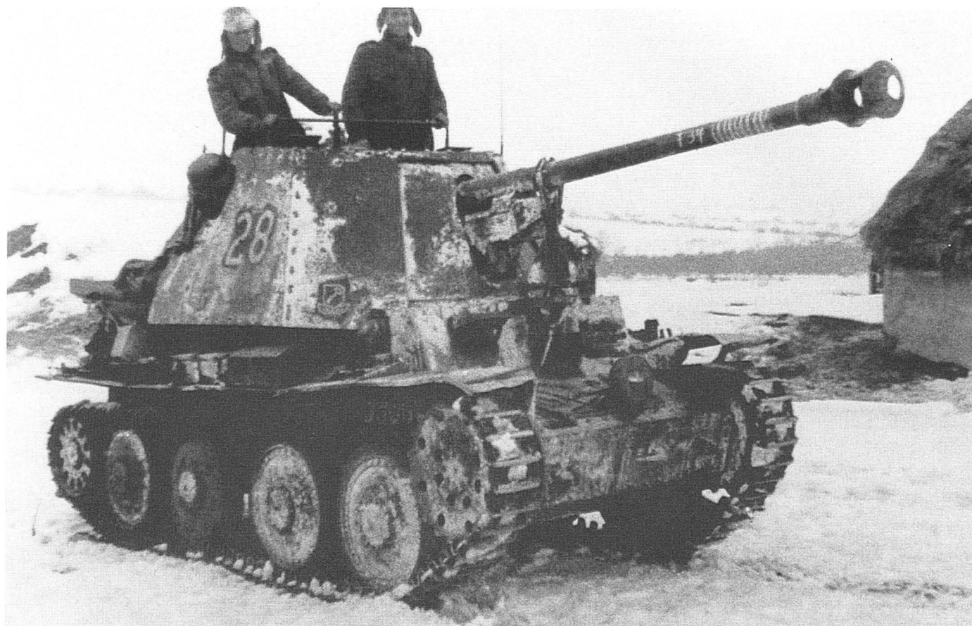
7,5 cm Pak 40/3 auf PzKpfw 38(t) Ausf. H Sd Kfz 138 „Marder III” nr „28” z 1. Dywizjonu Niszczycieli Czołgów SS „LSSAH”, marzec 1943 roku. An 7.5cm Pak 40/3 auf PzKpfw 38(t) Ausf. H Sd Kfz 138 “Marder III” AT SP gun coded “28” from the 1st SS-Panzerjäger Abteilung “LAH”, March 1943. [ASKM]
