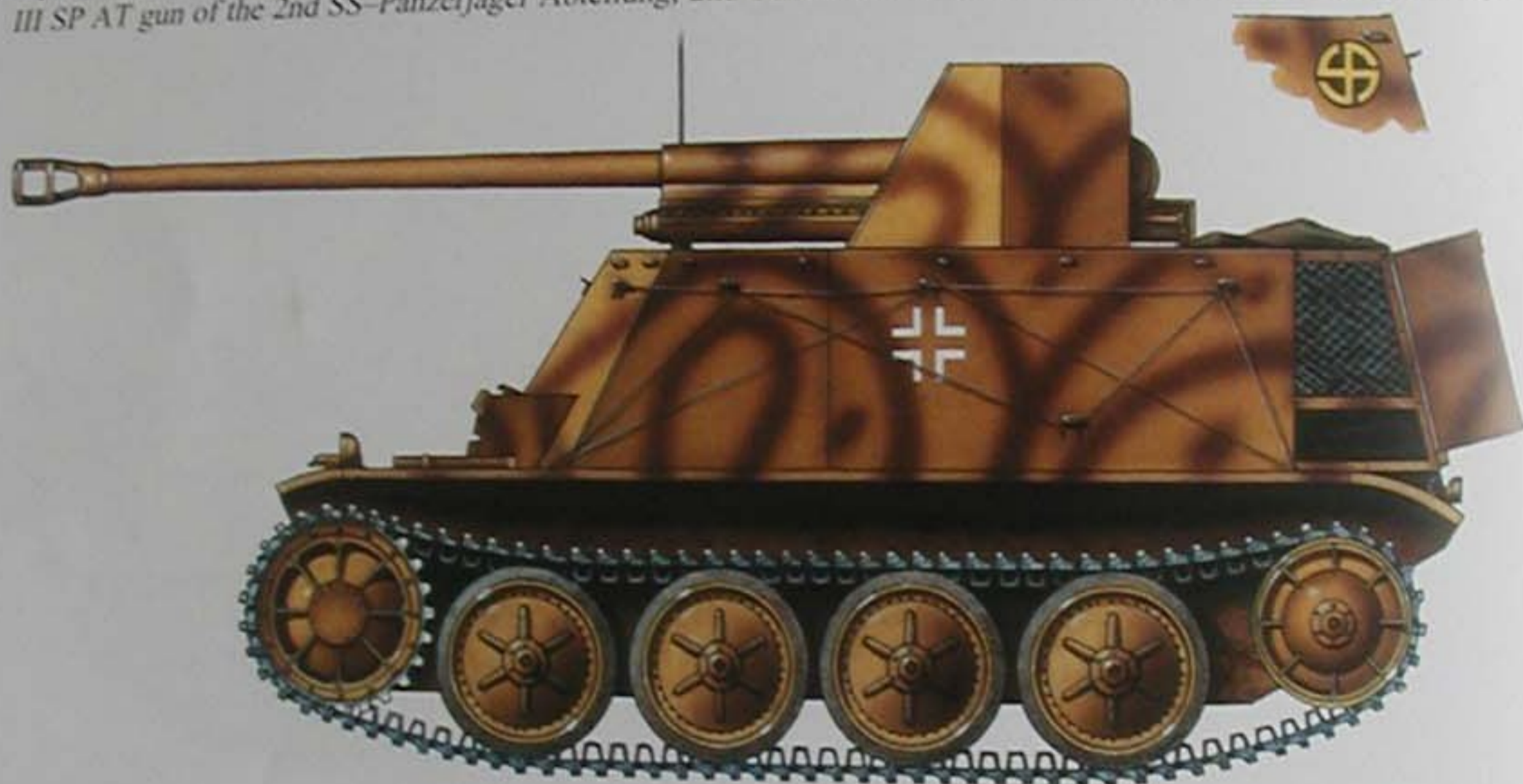
7,62 cm Pak 36(r) auf Fgst PzKpfw II Sd Kfz 132 „Marder“ II z 5. Dywizjonu Przeciwpancernego SS, 5. Dywizji Pancerniej SS „Wiking“, Polska, lato 1944 roku. 7.62 cm Pak 36(r) auf Fgst PzKpfw II Sd Kfz 132 „Marder“ II SP AT gun of the 5th SS-Panzerjäger Abteilung, 5th SS-Panzer Division “Wiking”, Poland, Eastern Front, Summer 1944.
