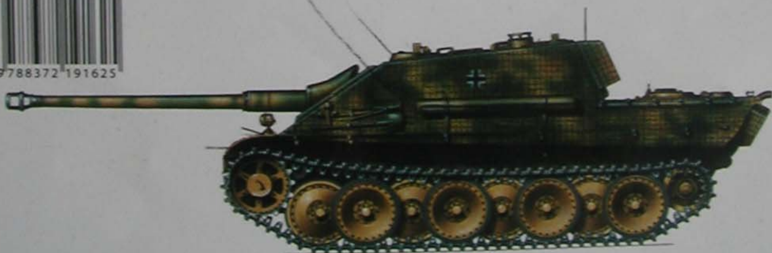
8,8 cm Pak 43 L/71 auf Fgst „Panther“ Kfz 173 „Jagdpanther“ z 9. Dywizjonu Przeciwpancernego SS, 9. Dywizji Pancerniej SS „Hohenstaufen“, Węgry, marzec 1945 roku. 8.8 cm Pak 43 L/71 auf Fgst „Panther“ Kfz 173 „Jagdpanther“ SP AT gun of the 9th SS-Panzerjäger Abteilung, 9th SS-Panzer Division „Hohenstaufen“, Hungary, March 1945.
