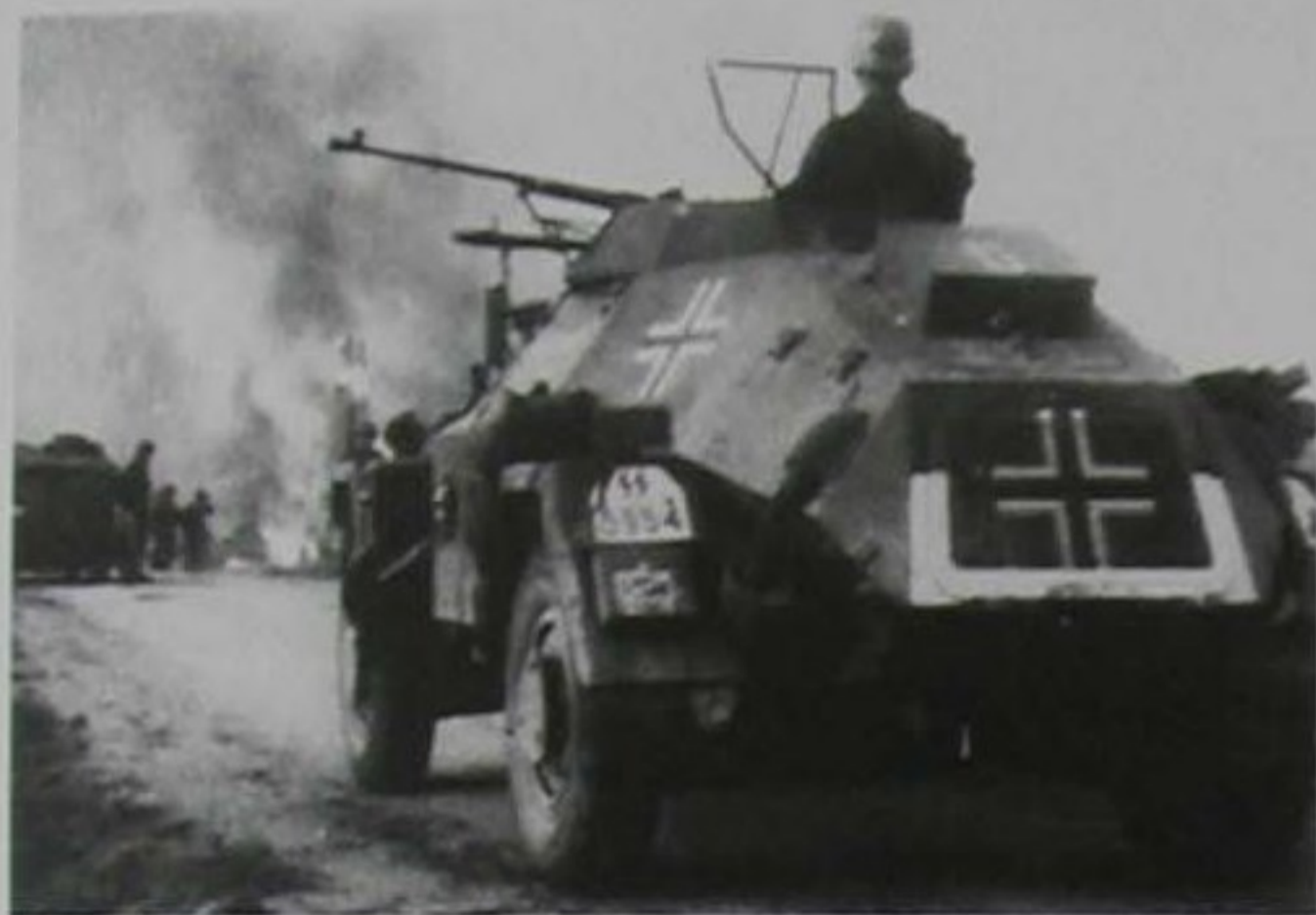
Samochód pancerny Sd Kfz 221 (4x4) „SS-5854” uzbrojony w rusznicę PzB 39 z Dywizji Zmotoryzowanej „Reich”, front wschodni, lato 1941 roku. A Sd Kfz 221 (4x4) armoured car coded “SS-5854” and armed with PzB 39 AT rifle of the SS-Division (motorisiert) “Reich”, Eastern Front, Summer 1941. [CAW]
