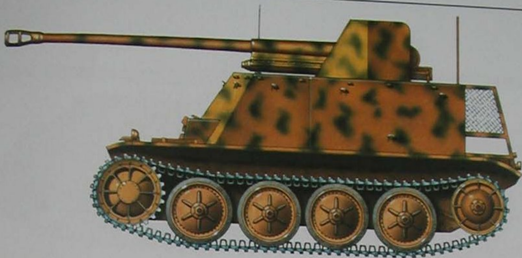
7,62 cm Pak 36(r) auf Fgst PzKpfw II Sd Kfz 132 „Marder“ II z 5. Dywizjonu Przeciwpancernego SS, Dywizji Zmotoryzowanej SS „Wiking“, front wschodni, lato 1943 roku. 7.62 cm Pak 36(r) auf Fgst PzKpfw II Sd Kfz 132 “Marder” II SP AT gun of the 5th SS-Panzerjäger Abteilung, SS-Division (motorisiert) “Wiking”, Eastern Front, Summer 1943.
