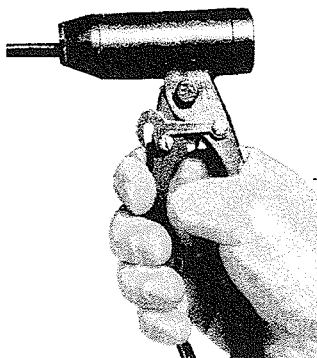
Figura 3.1.—Unión de mecha lenta a detonador
