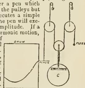
FIG. 5.—Tide-predicting instrument.
