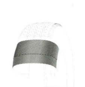
bias-ply tire neumático M de capas F al sesgo M pneu M à carcasse F diagonale Diagonalreifen M pneumatico M con carcassa F a struttura F diagonale
