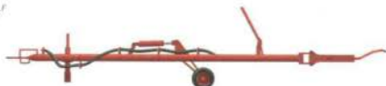
tow bar barra f de remolque m barre f de tractage m Abschleppstange f barra f di traino m
