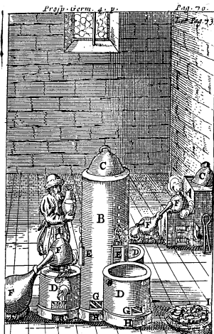
A. Ein kleiner Zinßbau mit ziner Pfing B. Ein Zinßbau mit 3 Pfing C. D. D. Zinßbau mit 2 Pfing D. D. D. Zinßbau mit 3 Pfing E. Die Register dadurch die Feuer regiret wird F. Daß eingestete Glas mit seinem Licht und Recipienten G. Die Thier zu dem Rißter H. Daß Aßchenloch I. Ein Körlein mit Kohlen
