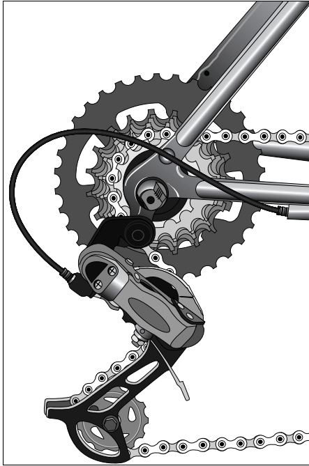
Figure 14-1: A rear derailleur.
