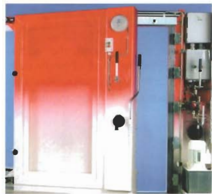
A watertight door
